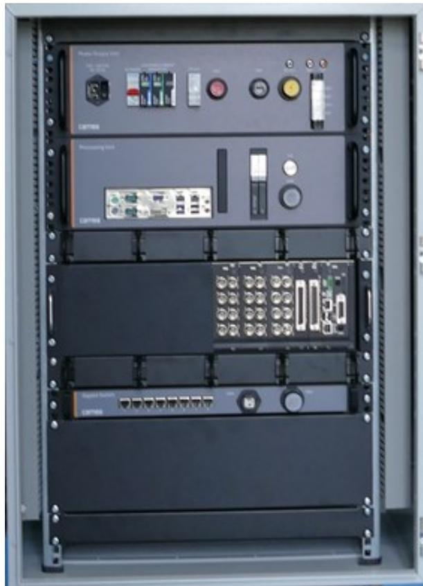
Рисунок 4 - Шкаф управления системы UnicomWIM с блоком обработки сигналов UC-ZPU (пример)
